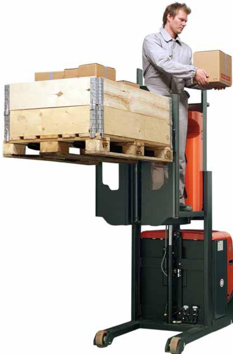
Der OSE100 eignet sich für Kommissionierarbeiten in der 1. und 2. Ebene. Er bietet einen sehr hohen Komfort, da sowohl die Plattform als auch die Gabeln angehoben werden können, und der Fahrer somit jederzeit direkten Zugang zum Lastenträger hat. Hohes Leistungsvermögen sowie eine ergonomische und verlässliche Konstruktion ermöglichen eine hohe Produktivität.
